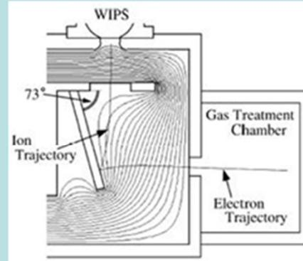
Fig. 4. Equipotential lines, ion and electron trajectories.
