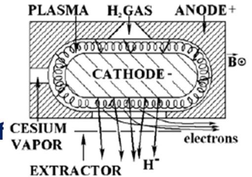
Figure 5 : Magnétron type source.[6]
