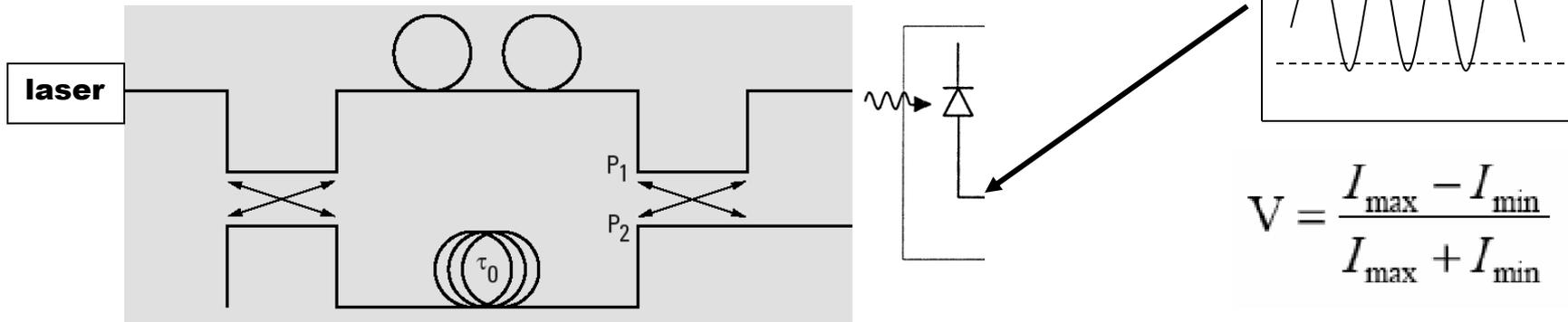
$$V = \frac{I_{\max} - I_{\min}}{I_{\max} + I_{\min}}$$
