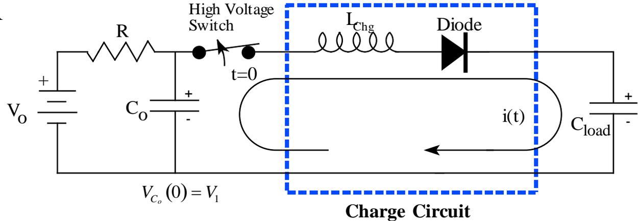
$$i_{C_o}(t) = \frac{V_0 - V_1}{R} e^{-\frac{t}{RC_o}}$$
