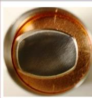
75µm Be e<sup>-</sup> Injection Window
