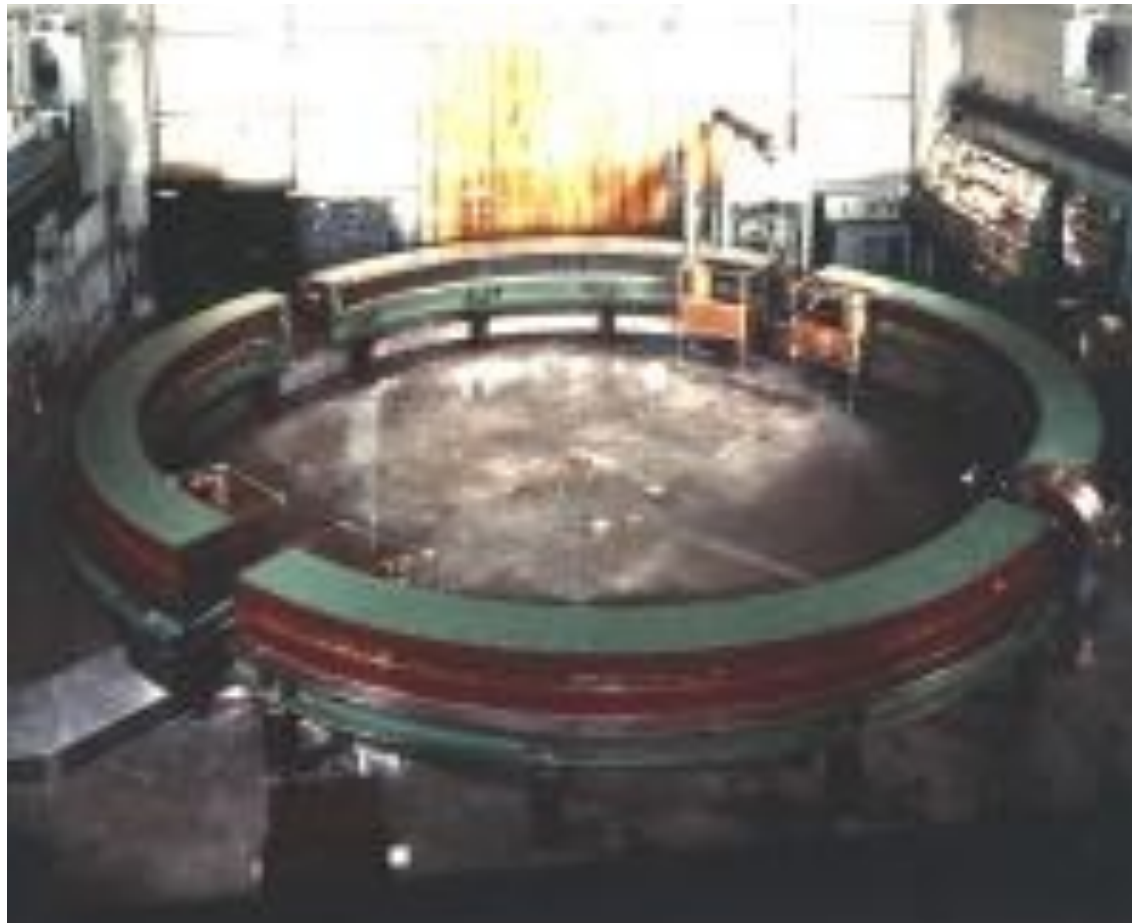
Cornell 1 GeV Electron Synchrotron (LEPP-AP Home Page)
